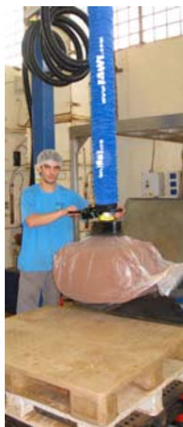
Typisk säcklyftsinstallation. Här: plasticsäcker med snabbkaffepulver.
