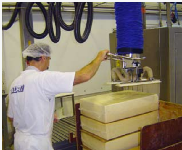
3. En rostfri VM200 max kapacitet 100 kg i rostfritt utförande. Används för lyft av hela ostblock i packavdelningen. Sugfoten är en standard art nr 620600 med vita lister.
