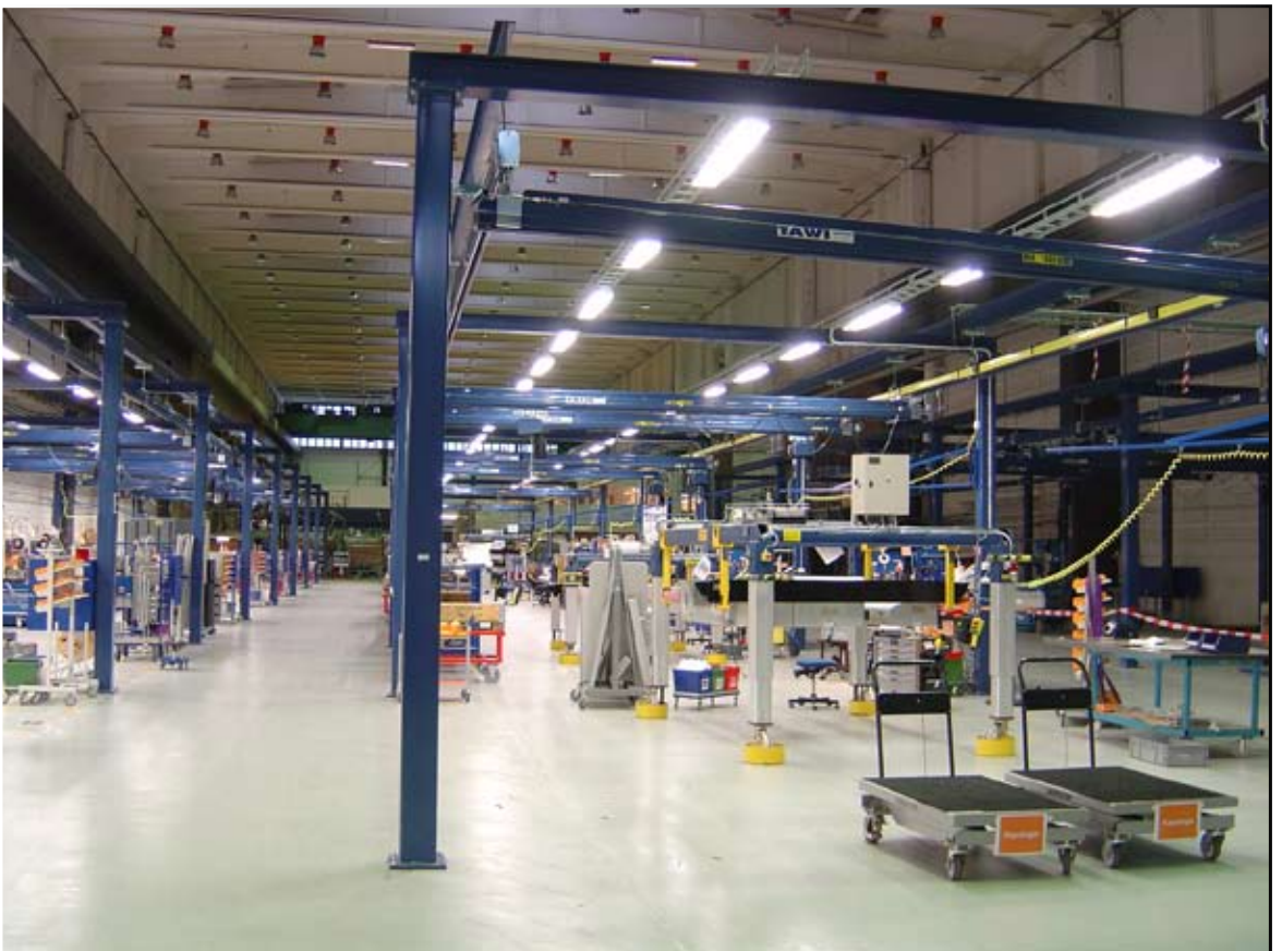
Portal cranes at Bombardier; Västerås, Sweden.
